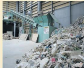
搬入されたプラスチック、木くずなど可燃系廃棄物を選別後、破砕機に投入
