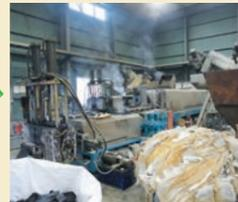
マテリアルリサイクル用の廃材はペレット加工機に投入され、約220度の熱を加えて溶融
