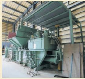
破砕された廃材を圧縮梱包機に投入
