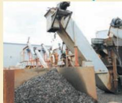
破砕機でさらに細かく破砕した後、水洗浄選別機でマテリアルリサイクル用とサマールリサイクル用に選別
