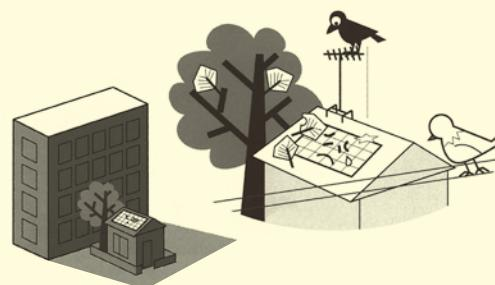
太陽光発電はその名の通り、太陽光が当たることで、発電をするため、設置の際はしっかりと日照条件を確認することが必要です。またパネルの上に鳥のフンなどがつくと発電低下につながりますので、アンテナの位置にも十分注意してください。その他に、表面の汚れは設置後数年ごとに、専門業者にメンテナンスを依頼し洗浄してもらうと安心です。設置の際に確認することをおすすめします。
